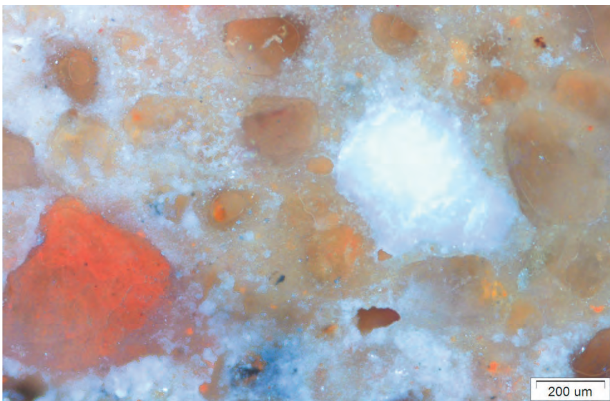
Fotografia przekroju poprzecznego tynku z próbki nr ŻG4, przybliżenie x40.
