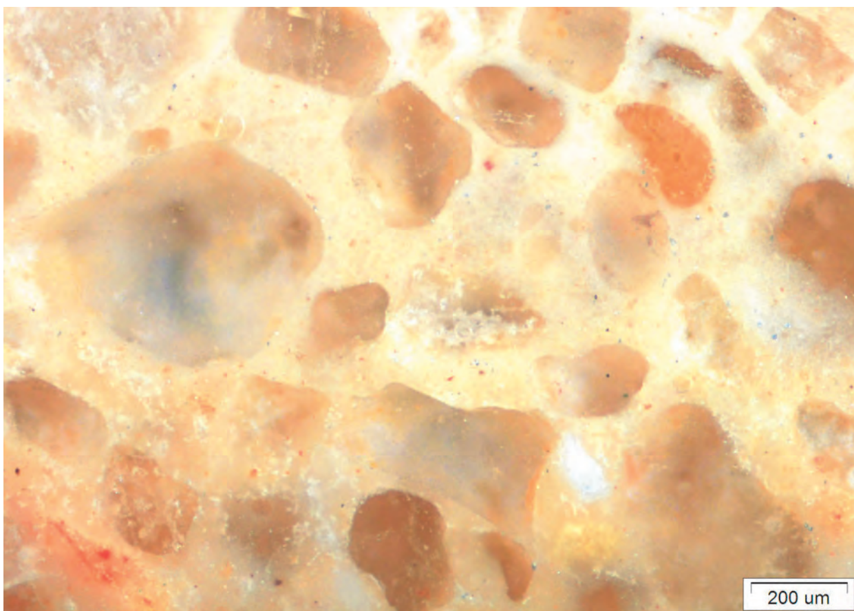
Fotografia przekroju poprzecznego tynku z próbki nr ŻG8, przybliżenie x40.
